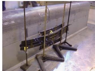
ケーブルのガンマ線照射試験
